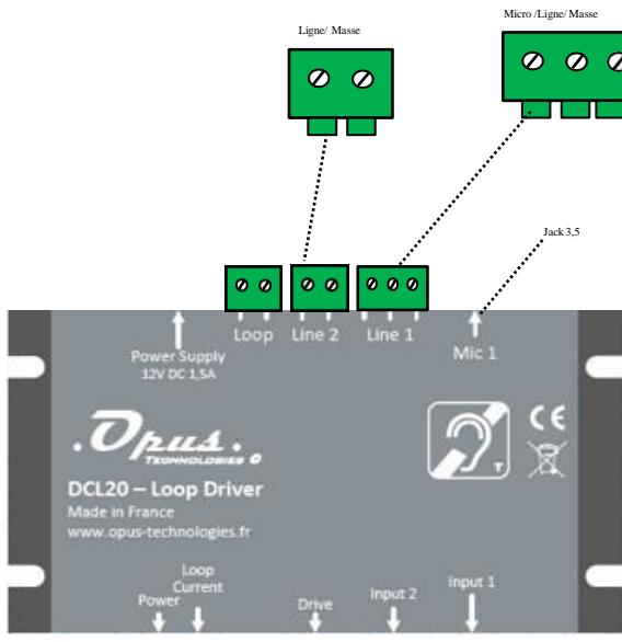
Pour connecter votre télévision sur le DCL20, connecter le câble fournit dans l'entrée ligne 1.
