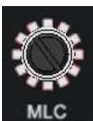
Si vous détectez une distorsion du signal due à une pollution magnétique tournez la commande MLC (Metal Loss Compensation) en façade de l'amplificateur dans le sens des aiguilles d'une montre.
