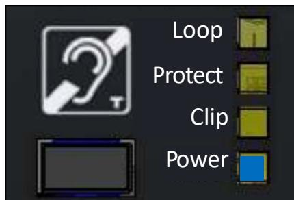
La mise sous tension de l'unité s'effectue grâce à l'interrupteur gris en façade de l'amplificateur, si l'amplificateur est alimenté la LED **Power** s'allume en bleu.
